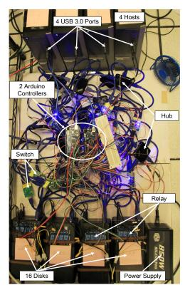
Fig. 4: UStore prototype.
